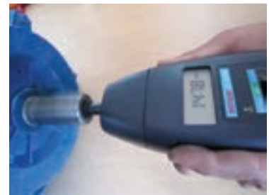
شکل ۴-۲۳ الف نحوه اندازه‌گیری مکانیکی سرعت موتور.
