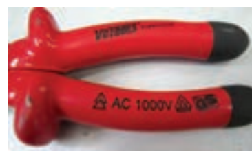
(الف) دسته عایق انبردست (در برابر ۱۰۰۰ ولت)
