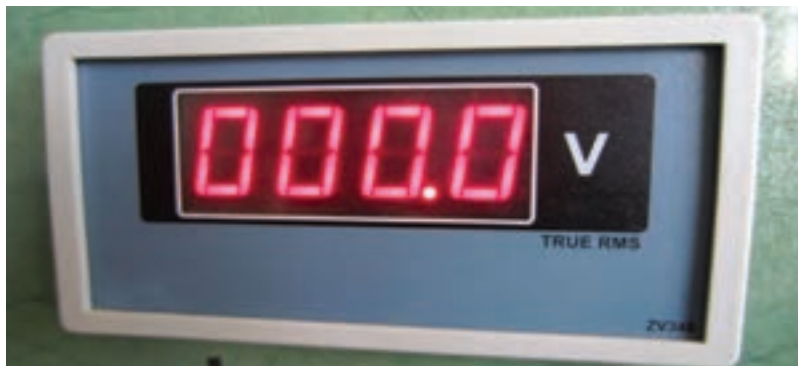
شکل ۱-۱۳ ب) ولت‌متر دیجیتالی
