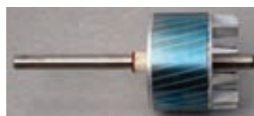
شکل ۴-۴۸ استاتور و روتور موتور آسنکرون تک فاز
