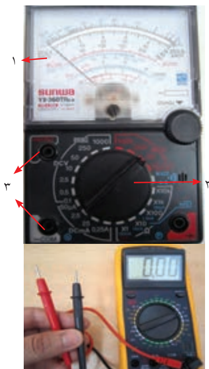
شکل ۱-۲۷ مولتی متر آنالوگ و دیجیتال
