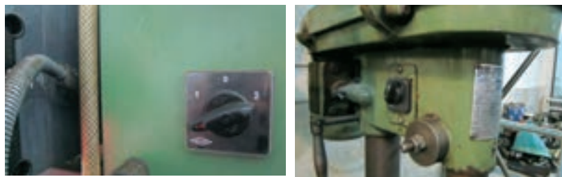
شکل ۵-۲۰ نمونه کاربردی کلید زبانه‌ای چپ گرد، راست گرد.
