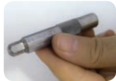
۱ به سطوح تخت چندوجهی (انتهای قطعه) و قسمت آجدار روی قطعه توجه کنید.
