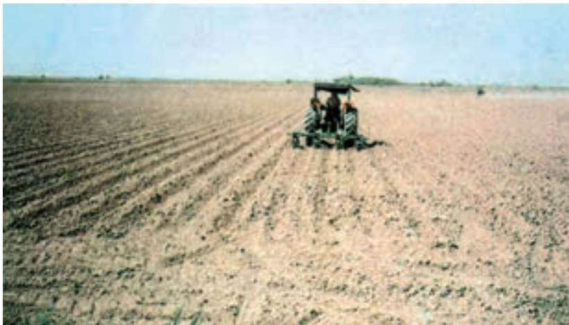
شکل ۱۳-۲ - دستگاه ردیف‌کار ذرت در حال کاشت ردیفی
