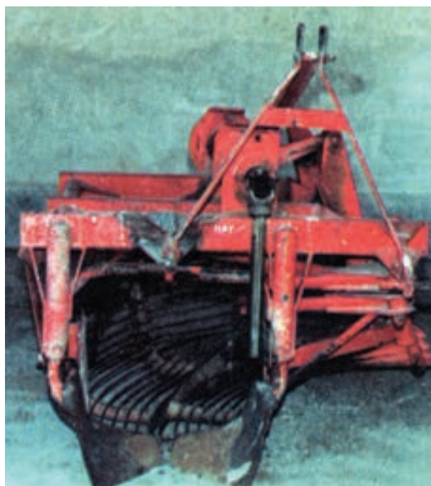
شکل ۲۱-۴- ماشین برداشت سیبزمینی با صفحه مشبک لوزان
