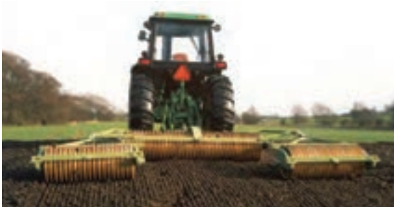
شکل ۳۴-۱ نحوه اتصال چند گروه غلتک حلقوی
