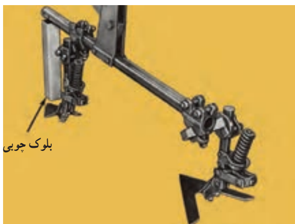
شکل ۱۲-۳- استفاده از قطعه چوب برای تراز پنجه
