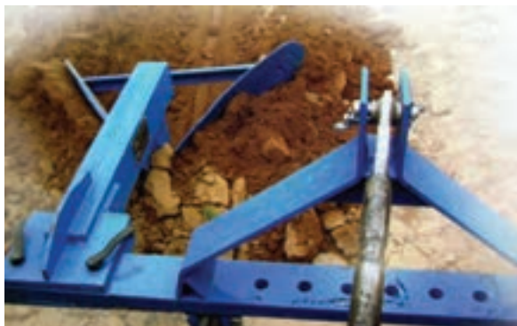
شکل ۴۸-۱- نهرکن کنشی در حین حفر نهر
