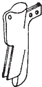
شکل ۲-۶- شیار بازکن کفشکی که برای اراضی خشک و خاک‌هایی که خوب تهیه شده‌اند، استفاده می‌شود.
