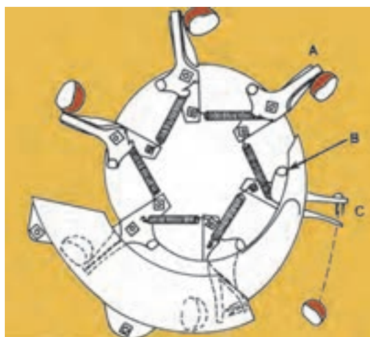
شکل ۱۸-۲- موزع سیبزمینی از نوع چنگک‌دار
