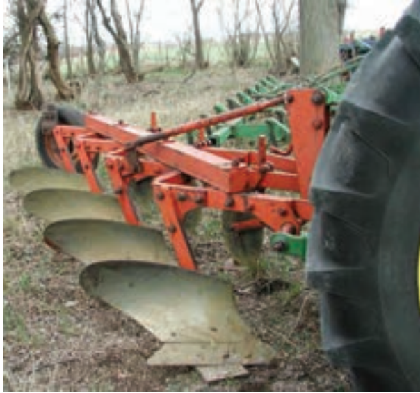
شکل ۲-۱- گاو آهن برگردان دار یک طرفه
