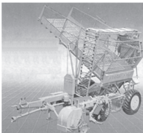
شکل ۲۷-۴- کمباین برداشت چغندر از نوع کششی
