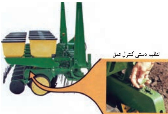
شکل ۸-۲- تنظیم عمق شیار بازکن‌ها با استفاده از میله مجهز به فنر در اشکال مختلف در ردیف کارها
