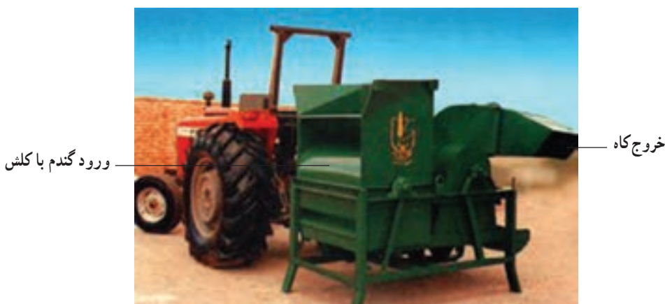
شکل ۱۷-۴ خرمن‌کوب متصل به تراکتور
