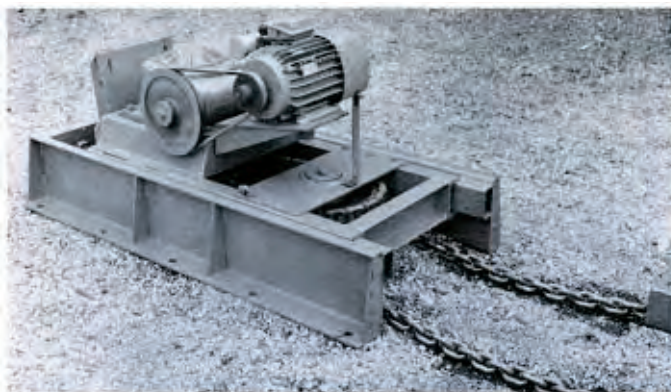
شکل ۲۶-۴- الکتروموتور و زنجیر محرک تیغه
