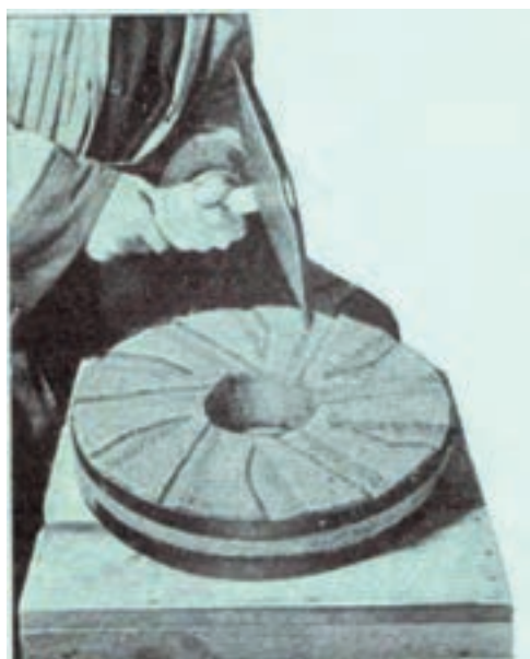
شکل ۳۹-۳- ایجاد شیار روی سنگ آسیا
