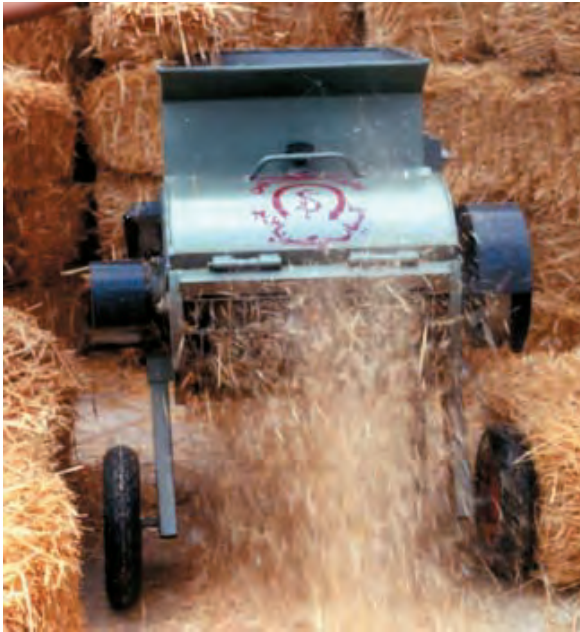
شکل ۳-۴- نحوه کار گاه خردکن
