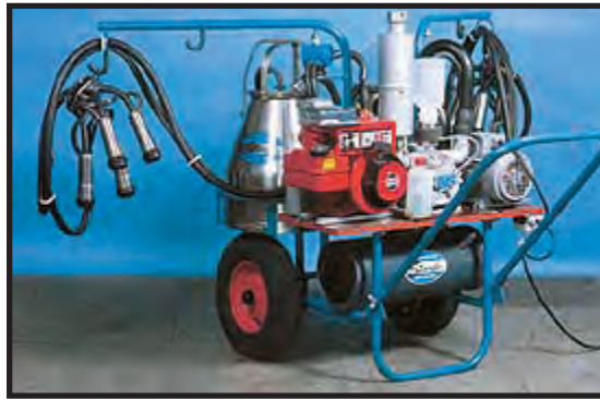
شکل ۴-۵۶- دستگاه شیردوش سیار
