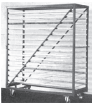
شکل ۳-۳ - قفسه‌های مخصوص شانه‌های تخم مرغ (راک)
