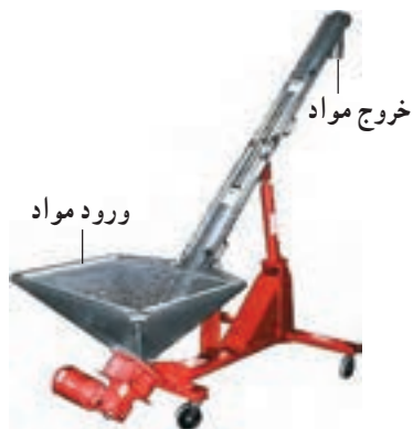
شکل ۱-۲۱- نقاله ماریچی شییدار با قابلیت جابه‌جایی و تنظیم شیب
