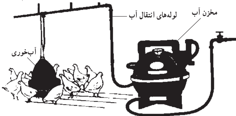
شکل ۶۱-۳- تجهیزات توزیع آب مکانیزه
