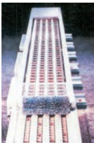
شکل ۷-۵- دستگاه درجه‌بندی وزنی
