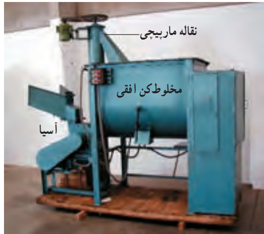
شکل ۴۳-۳- دستگاه آسیا مخلوط‌کن افقی
