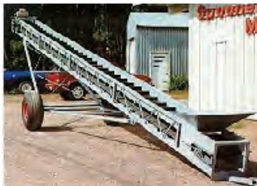
شکل ۳۰-۱- نقاله زنجیری شیبدار
