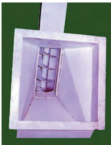
شکل ۱۵-۱- دریچه ورودی نقاله
