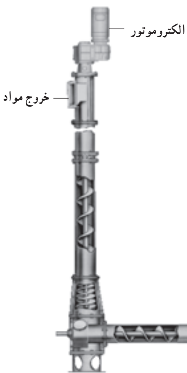
شکل ۱-۲۰- نقاله ماریچی مخصوص مسیرهای شییدار
