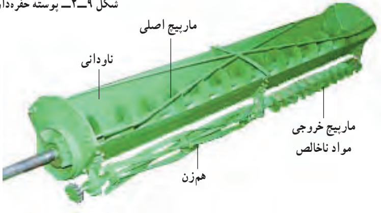
شکل ۲-۱۰ - اجزای داخلی استوانه حفره‌دار
