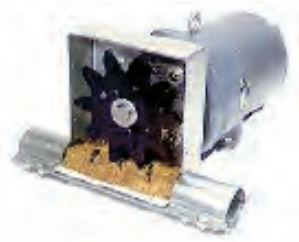
شکل ۳-۵۶- الکتروموتور و چرخنده محرک دان خوری ماریجی
