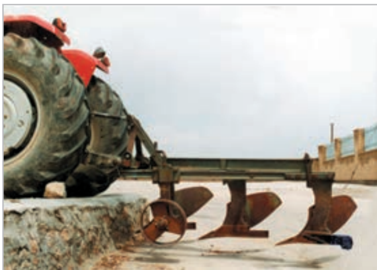
شکل ۲۶-۱- نحوه تنظیم عمق کار گاوآهن
