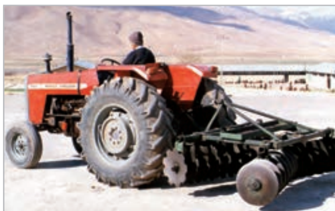
شکل ۲-۶- چنگه بشقابی سوار در حالت حمل
