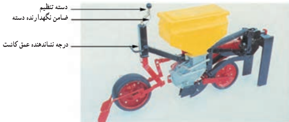
شکل ۱۷-۷- دسته تنظیم عمق پس از خواباندن ضامن با چرخاندن دسته، چرخ فشار بالا و پایین رفته و عمق کاشت را تغییر می‌دهد.
