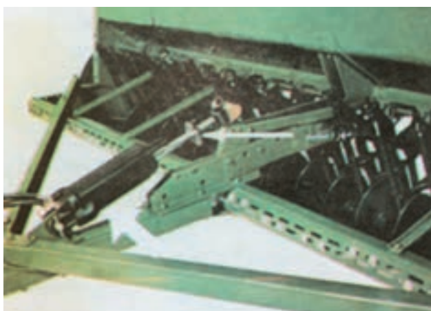
شکل ۱۵-۶- تنظیم عمق کاشت توسط جک هیدرولیک
