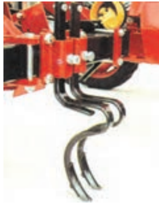
شکل ۱۰-۷. دندانه‌های پاک کننده اثر چرخ
