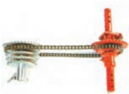
شکل ۱۱-۸ — زنجیر و چرخ زنجیر سیستم محرک موزع
