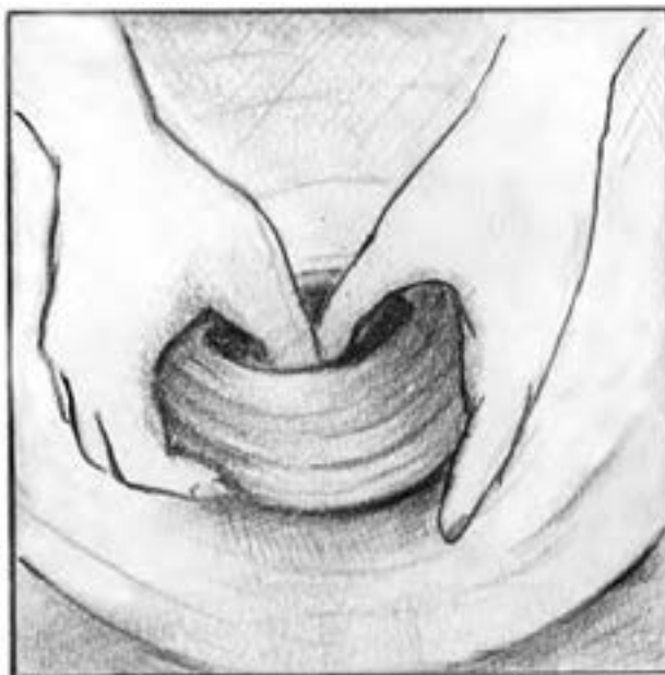
تصویر ۱۴۵- روش باز کردن گِل
