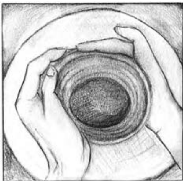
تصویر ۱۴۶- طریقه شکل دادن به دیواره طرف
