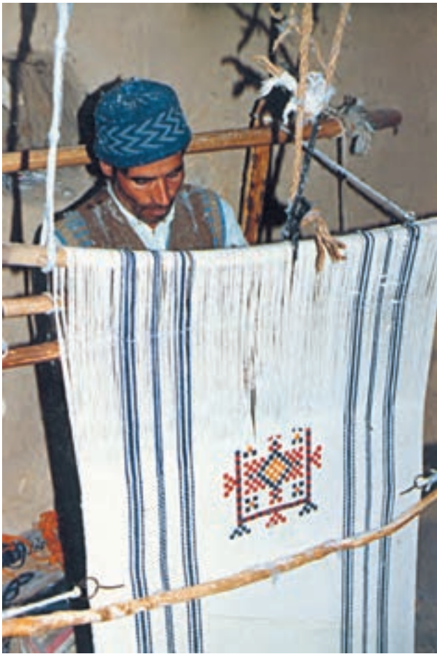
تصویر ۵۷- بافت خورجین بر روی دستگاه بافندگی - جرقویه - اصفهان
