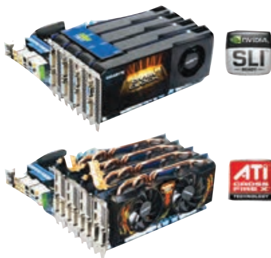
شکل ۲۵-۸ نصب کارت‌های گرافیک CrossFire و SLI
