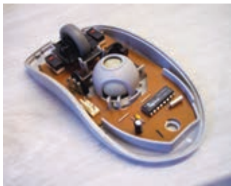
شکل ۲۶-۶ درون ماوس مکانیکی - نوری
