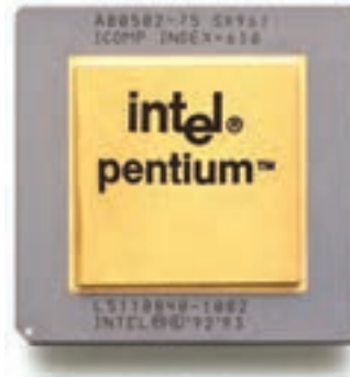
شکل ۲۸-۳ پردازنده پنتیوم ۷۵ و سوکت شماره ۵
