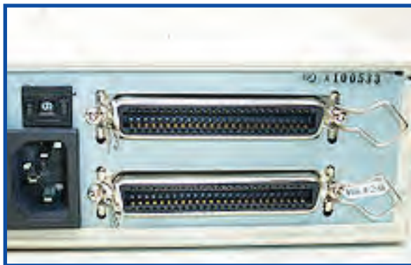
شکل ۴-۴۶ کانکتور اسکازی روی دیسک سخت خارجی
