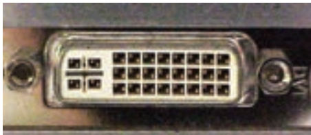
شکل ۱۷-۵ درگاه DVI برای اتصال به صفحه‌نمایش‌های دیجیتال
