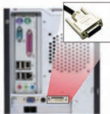
شکل ۱۷-۵ درگاه DVI برای اتصال به صفحه‌نمایش‌های دیجیتال
