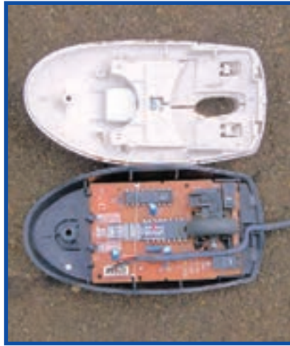
شکل ۲۷-۶ نمایی از درون ماوس نوری
