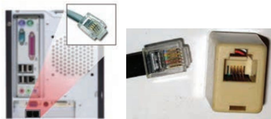
شکل ۳۱-۵ محل اتصال کابل‌های مودم به پشت کیس مربوط به مودم‌های داخلی و پریز تلفن
