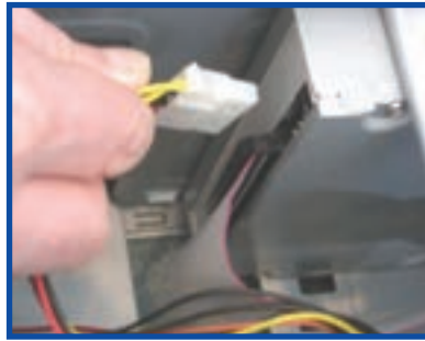
شکل ۲۳-۸ اتصال کابل برق دیسک گردان نوری
