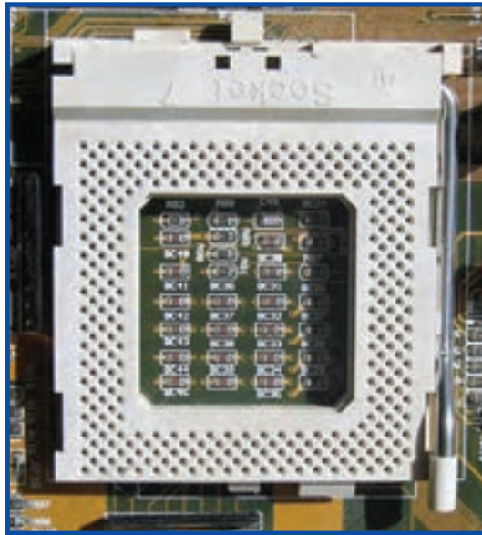
شکل ۲-۶ سوکت پردازنده از نوع ZIF
