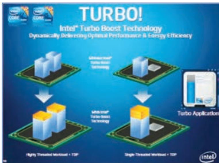
شکل ۴۱-۳ فناوری Turbo Boost در پردازنده‌های چند هسته‌ای سری‌های Core i5 و Core i7
