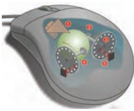
شکل ۲۶-۶ درون ماوس مکانیکی - نوری
