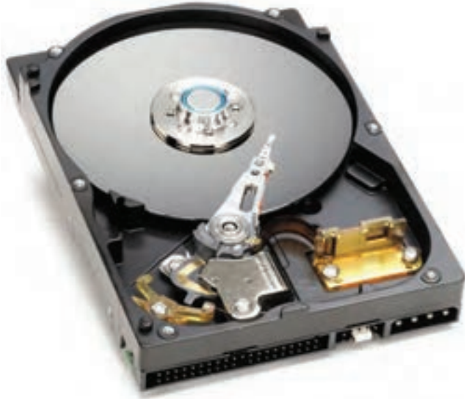
شکل ۲۹-۴ نمای داخلی دیسک سخت
