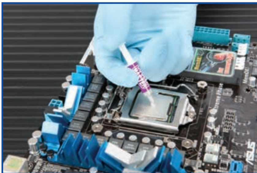
شکل ۷-۸ پوشاندن پردازنده با خمیر انتقال حرارت
