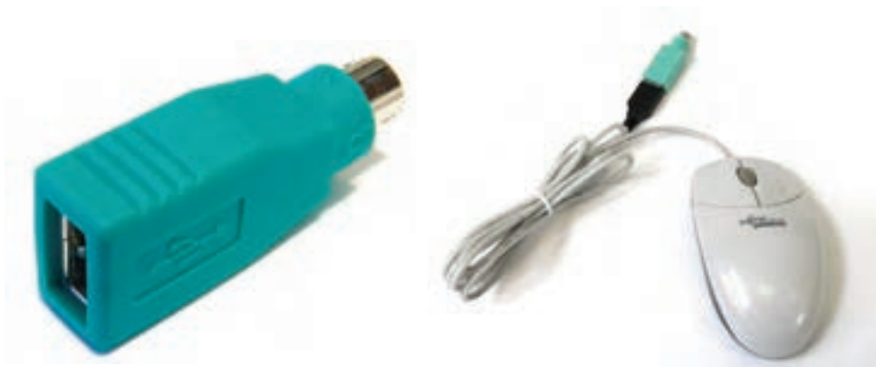
شکل ۲۸-۶ تبدیل USB به رابط PS/2 برای ماوس
