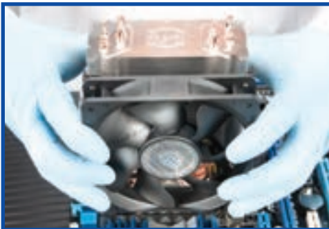
شکل ۸-۹ نصب خنک کننده پردازنده
