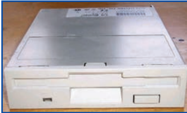
شکل ۲۸-۴ نمونه‌ای از فلاپی دیسک و دیسک‌گردان آن
