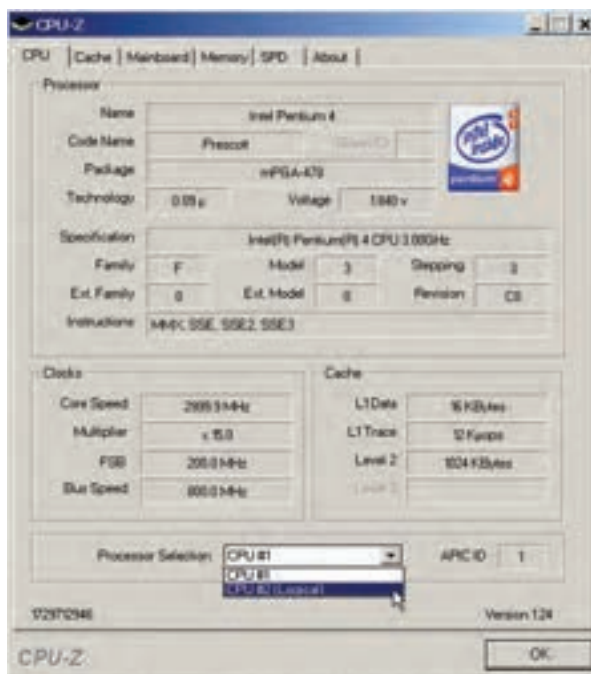
شکل ۳-۶ نمایش مشخصات پردازنده با نرم افزار CPU-Z
