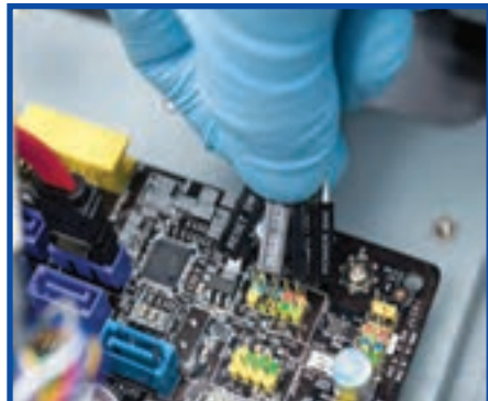
شکل ۱۹-۸ نصب و اتصال کانکتورهای پانل جلوی کیس
