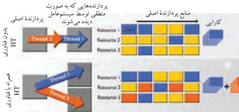
شکل ۱۴-۳ استفاده بیشتر از منابع مختلف پردازنده با استفاده از فناوری HT
