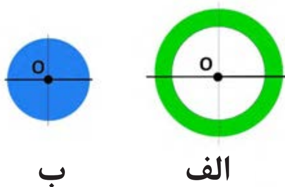
شکل ۶-۱۵ ممان اینرسی قطبی برای دو سطح مقطع متفاوت
