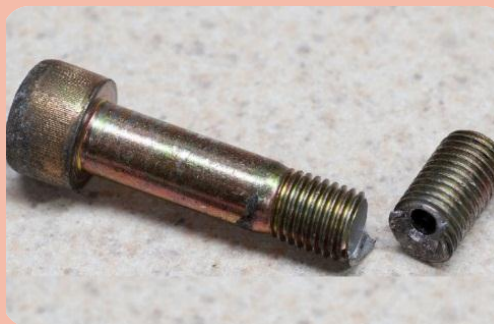
یک پیچ بریده شده بر اثر بارگذاری پیچشی
