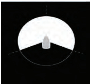
شکل ۱-۴- زاویه دید چراغ دکل اصلی شناور
