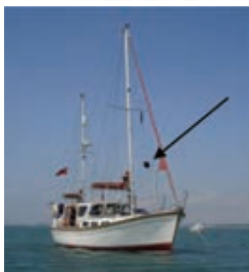
شکل ۴۴-۴- چراغها و علائم بصری شناور در لنگر
