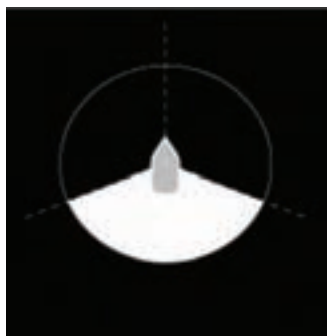
شکل ۴-۵- زاویه دید چراغ پاشنه شناور
