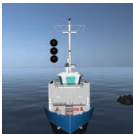
شکل ۴۵-۴- چراغ‌ها و علائم بصری شناور به گل نشسته
