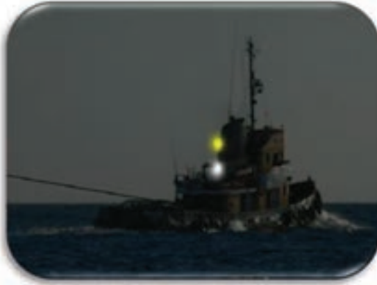
شکل ۱۸-۴- چراغ‌های پاشنه شناور یدک کننده
