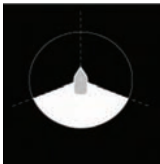
شکل ۴-۵- زاویه دید چراغ پاشنه شناور
