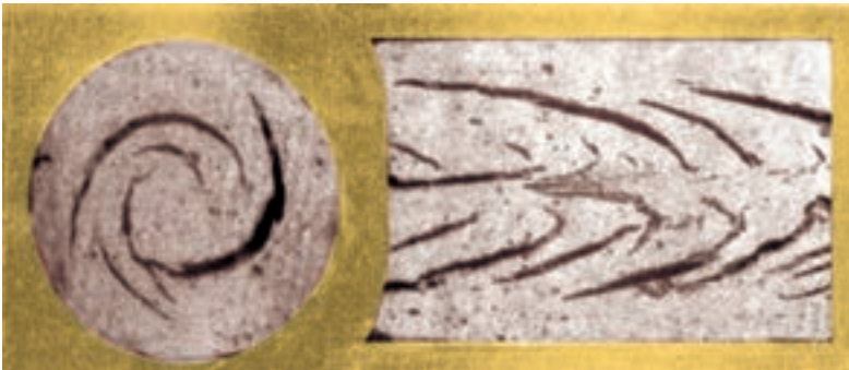
شکل ۲۸-۱- لایه لایه شدن در مقطع گل
