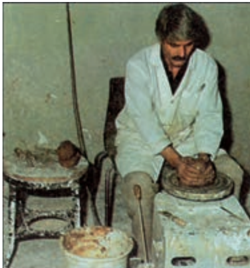
شکل ۴-۱- گل در مرکز چرخ قرار داده می‌شود.
