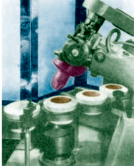
شکل ۳۸-۱- شکل دادن به فنجان با دستگاه رولر
