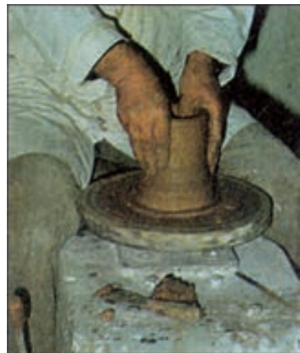
شکل ۱-۶- برای ساخت استوانه‌ی توخالی انگشتان شست درون گل فرو برده می‌شود.
