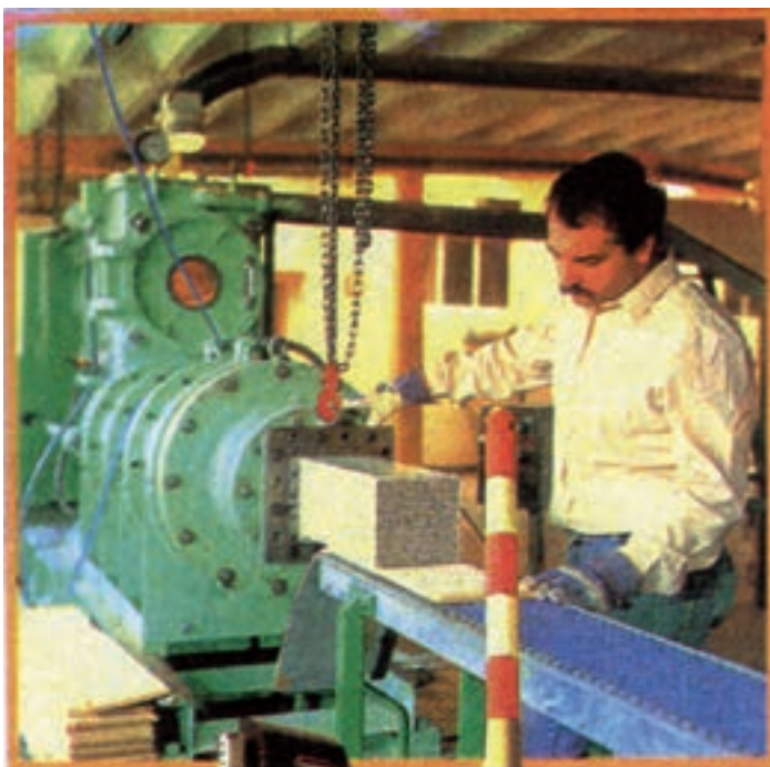
شکل ۲۱-۱- بلوک‌های مشبک و لانه‌زنبوری در حال شکل یافتن به وسیله‌ی پاگمیل
