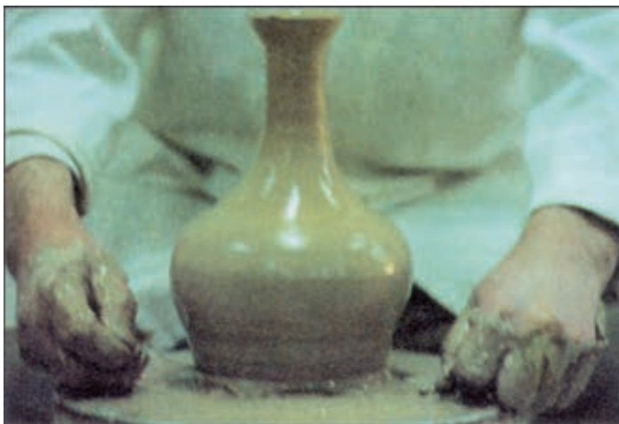
شکل ۱۳-۱- جدا کردن محصول به وسیله‌ی سیم نازک از سرچرخ
