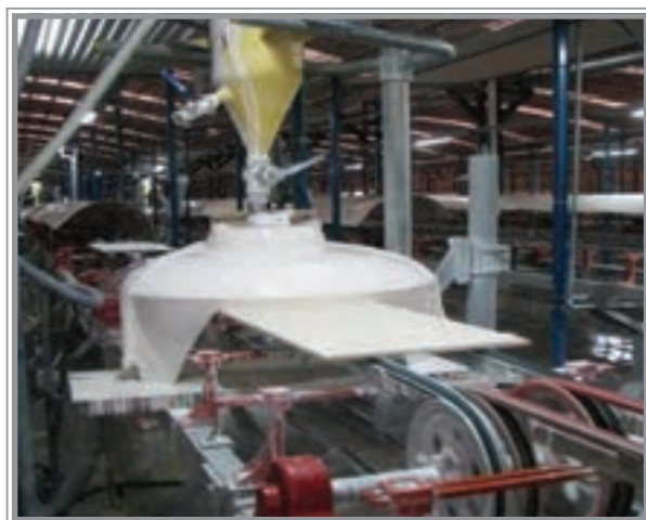
شکل ۲۸- لعاب‌زنی به روش آبشاری
