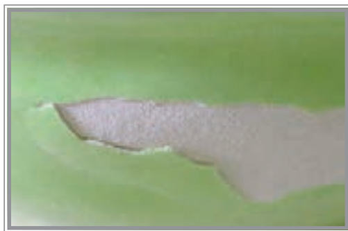
شکل ۳۳- عیب پوسته شدن لعاب
