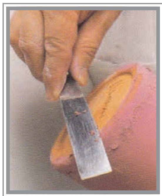
شکل ۱۹- پاک کردن کف قطعه از لعاب
