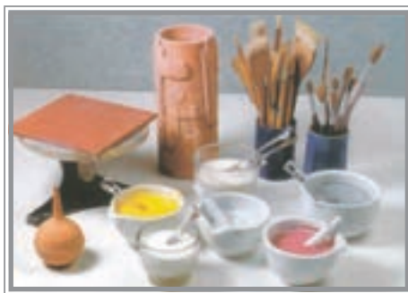
شکل ۱۴- تجهیزات مورد استفاده جهت لعاب‌زنی با قلم‌مو
