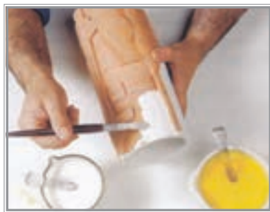
شکل ۱۵- اعمال لعاب بر روی سطح بیرونی قطعه
