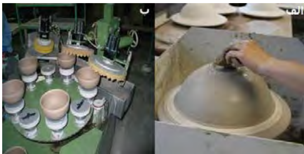
شکل ۲۲- پرداخت نمونه به روش (الف) دستی - (ب) اتوماتیک
