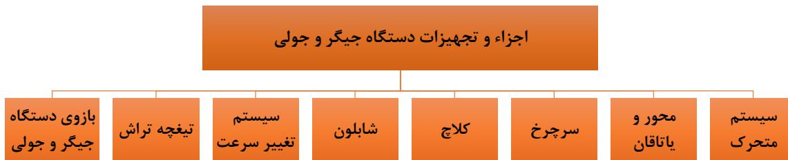
شکل ۱۴- اجزا و تجهیزات دستگاه جیگر و جولی
