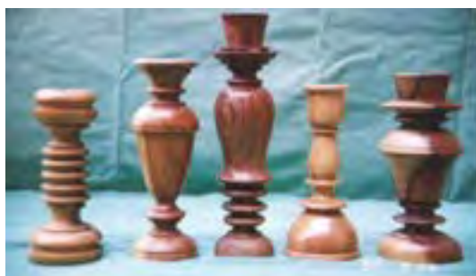
شکل ۲- قطعات چوبی شکل داده شده با تراش
