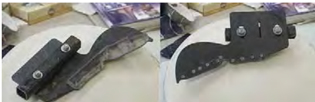
شکل ۲۰- شابلون با پیچ و مهره قابل تنظیم
