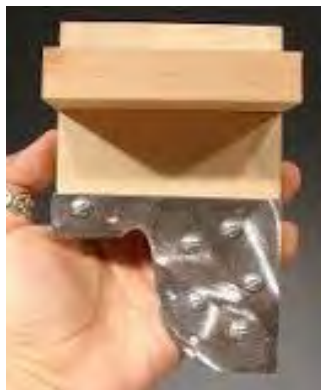
شکل ۱۸- شابلون تقویت شده با چوب
