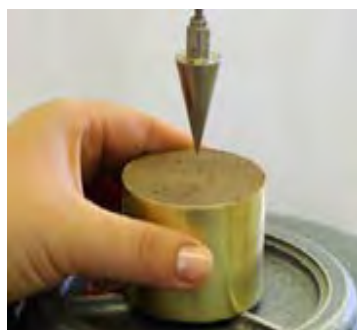
شکل ۴- دستگاه‌های کاربردی برای تعیین پلاستیسیته
