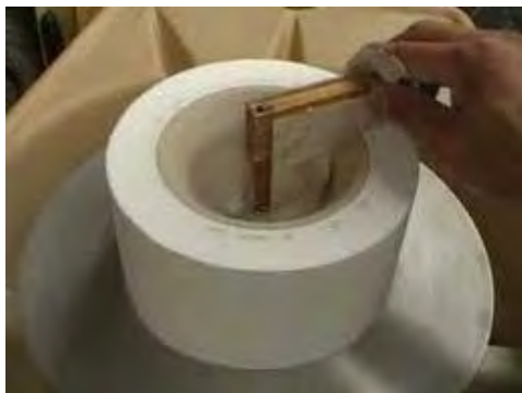
شکل ۳۹- پایین آوردن بازوی جولی و شکل‌دهی
