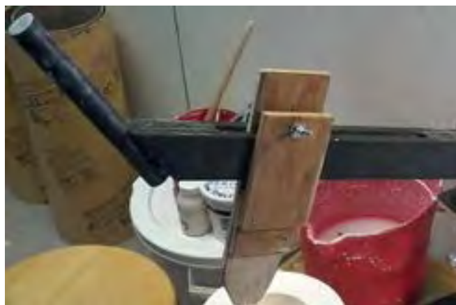
شکل ۱۹- شابلون چوبی و پلاستیکی تقویت شده با چوب
