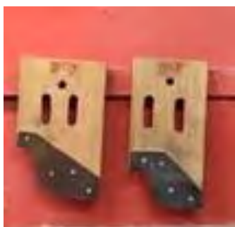
شکل ۱۷- انواع شابلون مورد استفاده در شکل‌دهی با استفاده از روش جیگر و جولی
