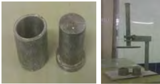
شکل ۱۷- دستگاه ففرکورن و قالب نمونه‌ساز
