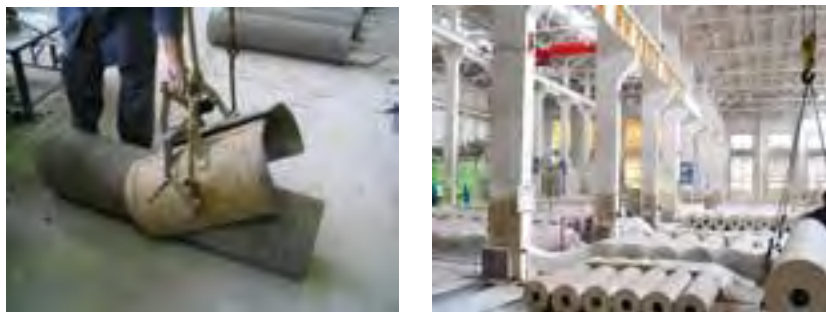
شکل ۲۲- جابه‌جایی شمش‌ها به کمک جرثقیل
