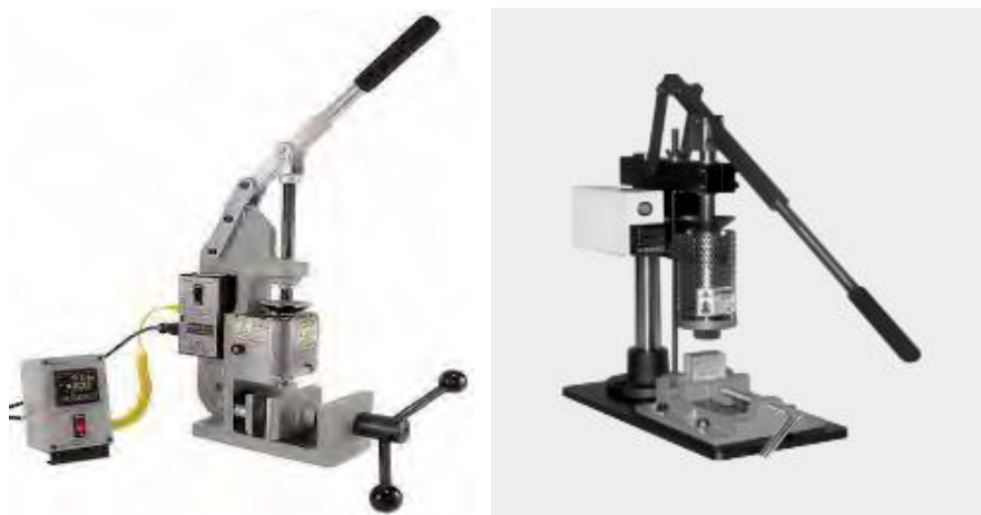
شکل ۲۱- دستگاه نیمه‌اتوماتیک (دستی) قالبگیری تزریقی
