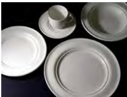
شکل ۵- قطعات تولیدشده به روش جیگر و جولی
