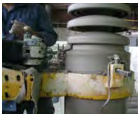
شکل ۵- شکل‌دهی قطعات سرامیکی به روش تراش
