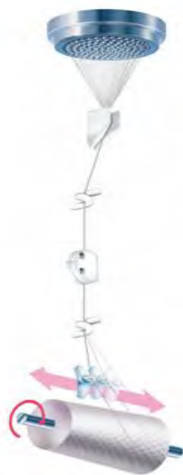
شکل ۲- قطعات سرامیکی مورد استفاده در تاباندن نخ
