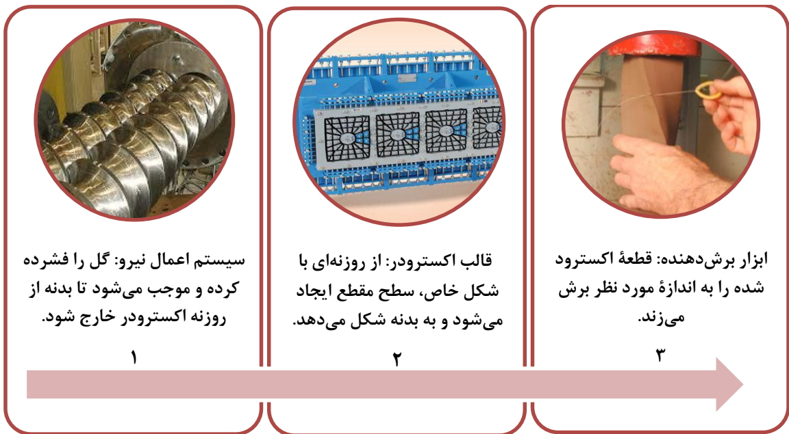
شکل ۶- اجزاء ماشین اکسترودر
