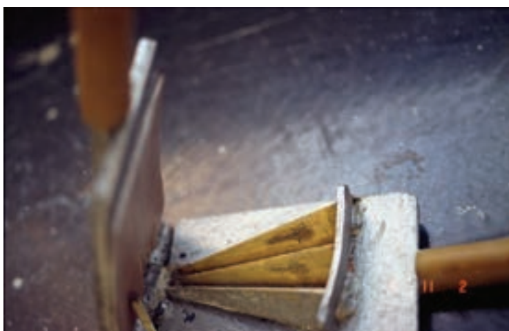
شکل ۳-۲۴- قالب ویژه ساخت مخروط‌های سنجش دمای خمیری [۷]
