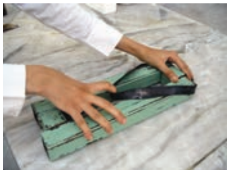
شکل ۲-۱۳- بستن قالب با نوار لاستیکی
