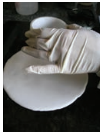
شکل ۲-۵- ب- بلند نمودن حلقه ویکات و چریان یافتن دوغاب گچ شکل ۲-۶- اندازه گیری قطر (سیالیت) دوغاب گچ جریان یافته
