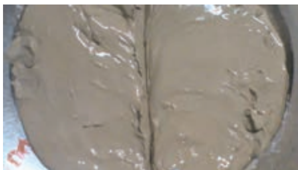
شکل ۳-۴ مرز یکی شدن شیار
