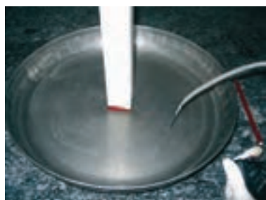
شکل ۲-۲۱- قرار گرفتن منشور روی پایه و افزودن آب برای برقراری ارتباط آن با قاعده منشور
