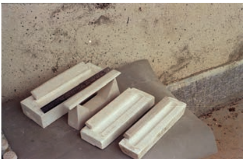
شکل ۳-۲۳- قالب گچی ویژه ساخت نمونه مقاومت پخت
