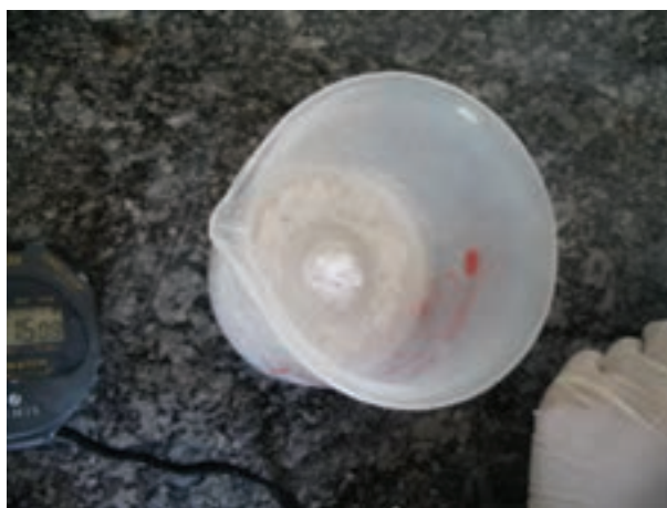
شکل ۱-۲- وضعیت پایانی پودر گچ در آزمون ماکزیمم نسبت گچ به آب
