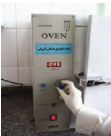
شکل ۲-۱۷- تنظیم خشک کن روی دمای ۴۵ درجه سلسیوس
