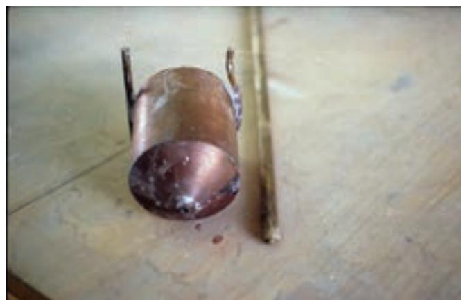
شکل ۳-۱۴- دهانه خروج و میله مسدود کننده دهانه خروج ویسکوزیومتر ریزشی
