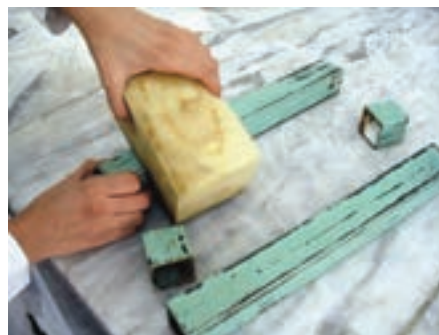
شکل ۲-۱۲- روغنکاری قالب ویژه آزمون نفوذ پذیری گچ
