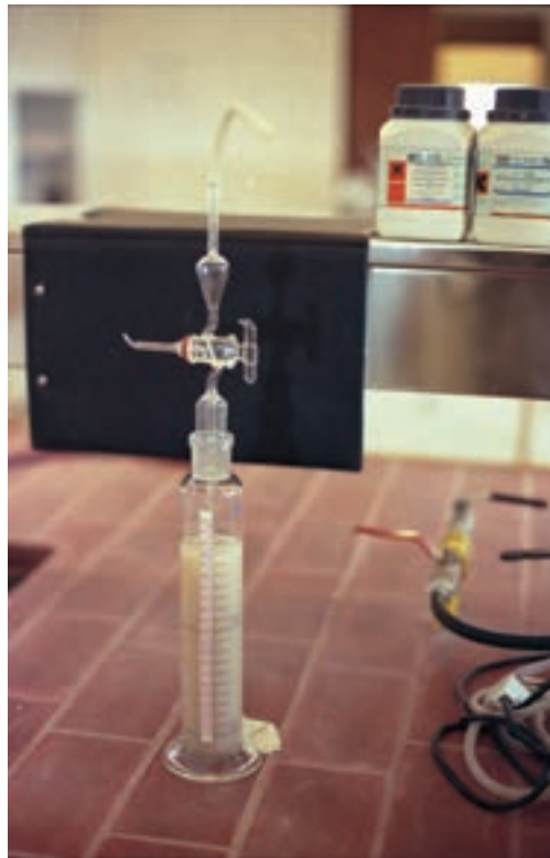
شکل ۴-۳- استوانه شیشه ای آندریازن در عمل
