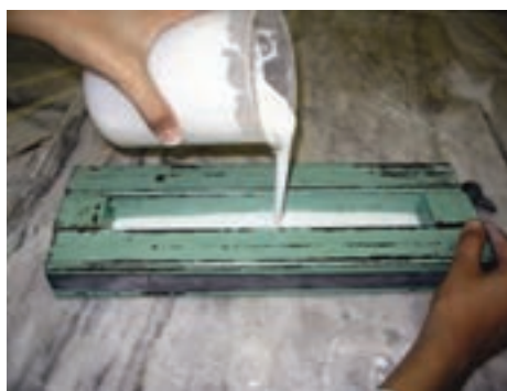
شکل ۲-۱۴- تخلیه دوغاب گچ داخل قالب
