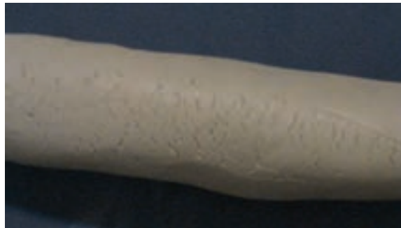
شکل ۳-۵ ظهور اولین ترک‌ها در گل بالکی آماده (ظهور ترک‌ها در روش آتربرگ)
