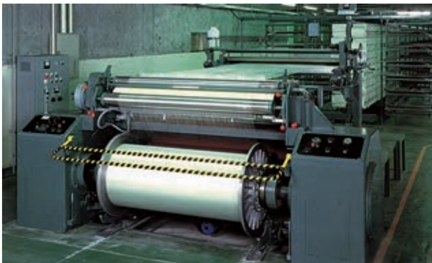
شکل ۲-۵ - دستگاه چله پیچی مستقیم
