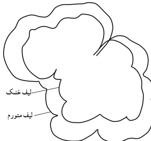
شکل ۶-۷- نمای مقطع عرضی فیلامنت ویسکوزیون قبل و بعد از تورم
