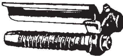
شکل ۴-۱۹- کناره‌گیر (تمپل) سوزنی
