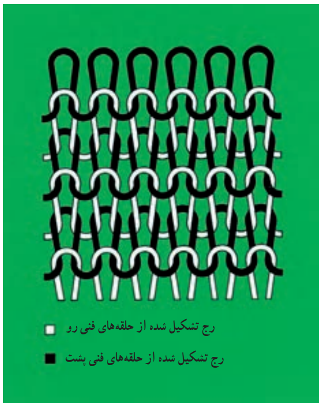
شکل ۱۰-۶- ساختمان بافت ساده دوبله سیلندر
