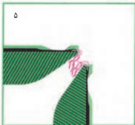
شکل ۱۰-۲- مراحل تشکیل حلقه‌ی بافت در ماشین‌های گردباف دو سیلندر مجهز به سوزن زبانه‌دار
