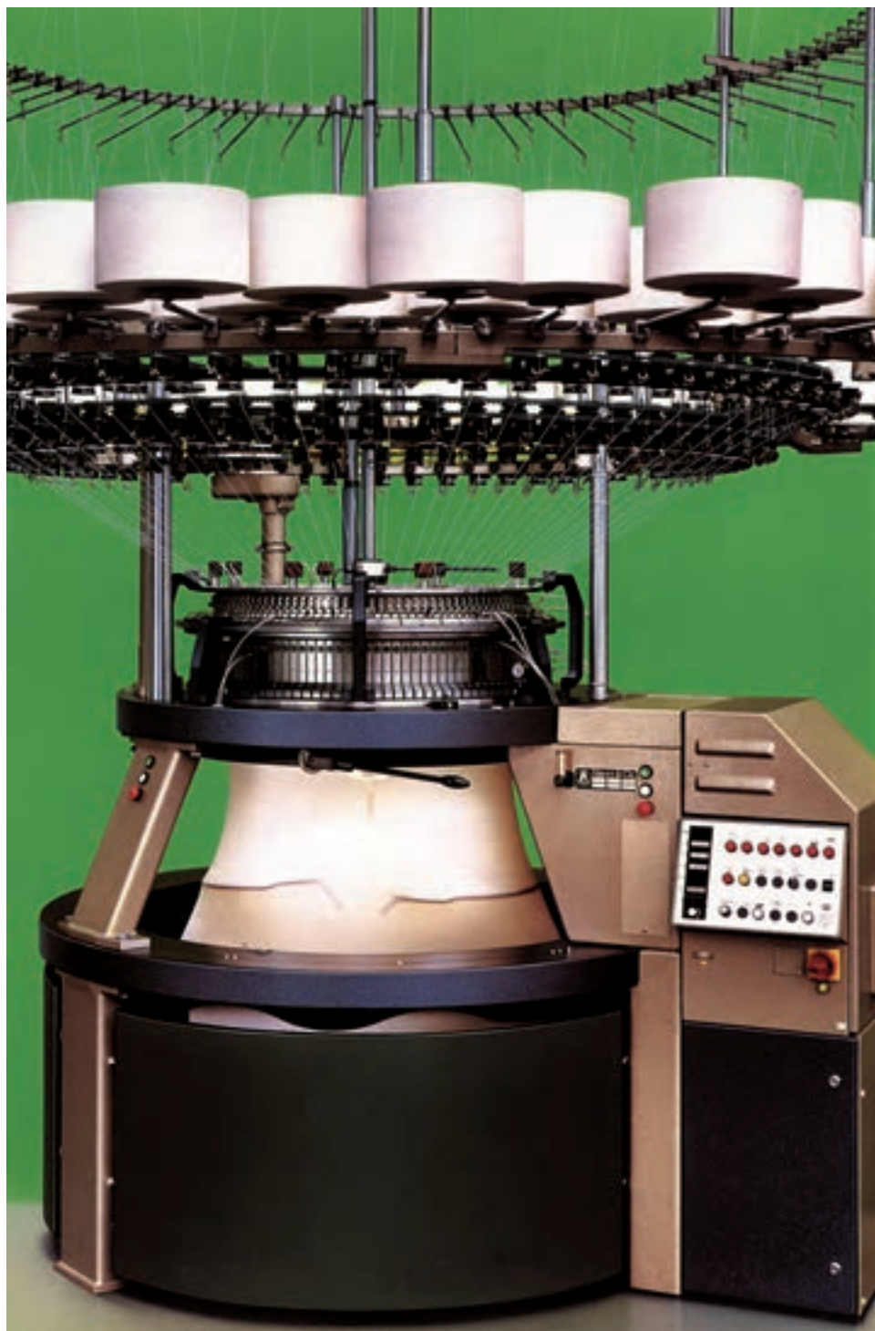
شکل ۱-۸ - نمای ظاهری ماشین گردباف یک سیلندر مجهز به سوزن زبانه‌دار
