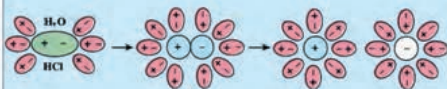
شکل ۵-۲. طرحی از یونیزاسیون \text{HCl} و آبپوش شدن یونها
