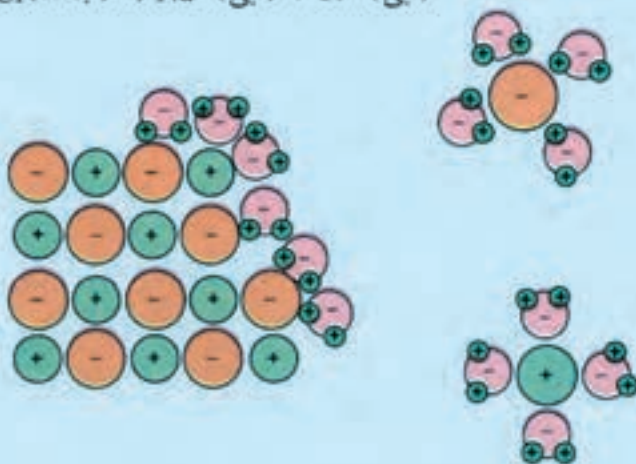
شکل ۵-۱ - طرحی از تفکیک جامد یونی در آب و آبپوش شدن یونها
