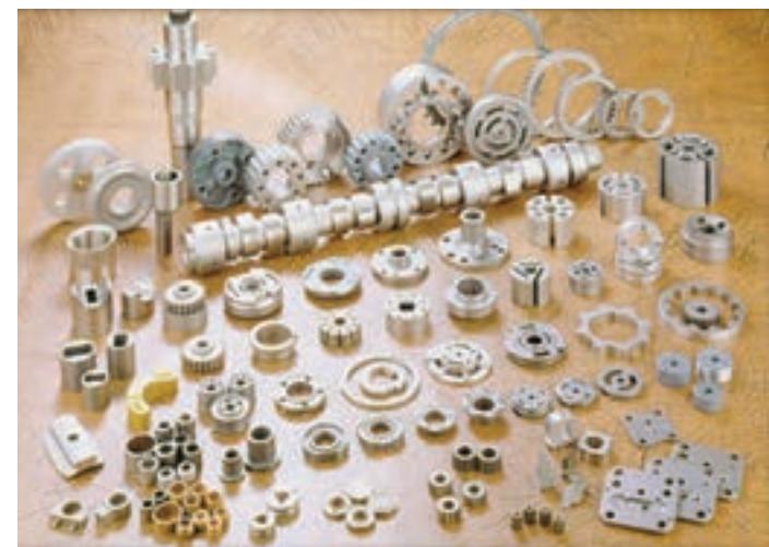
شکل ۱۶-۳- تعدادی از قطعات صنعتی که به روش متالورژی پودر تهیه شده‌اند.
