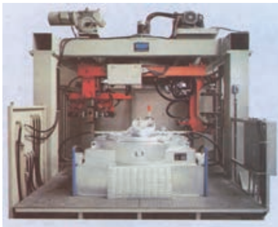
شکل ۲۸-۳- ماشین ریخته‌گری تحت فشار کم
