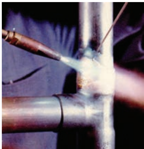
شکل ۱۴-۳- تکنیک جوشکاری به روش اکسی استیلن
