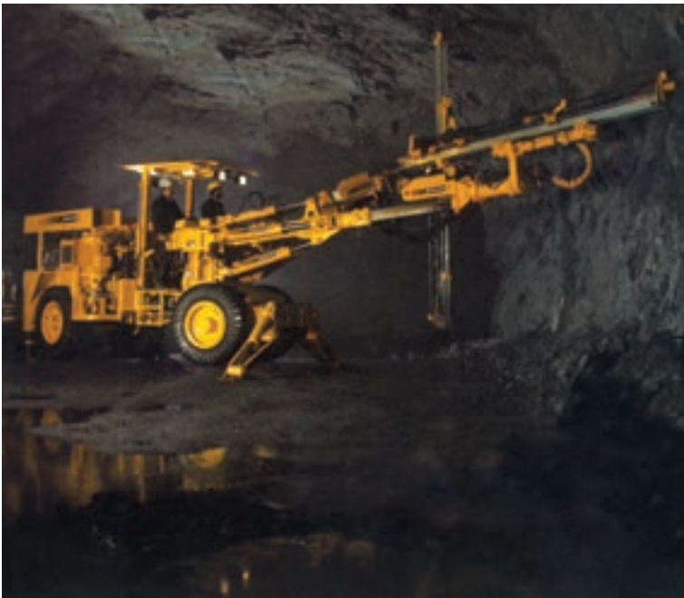
شکل ۱-۶- حفاری در یک معدن زیرزمینی
