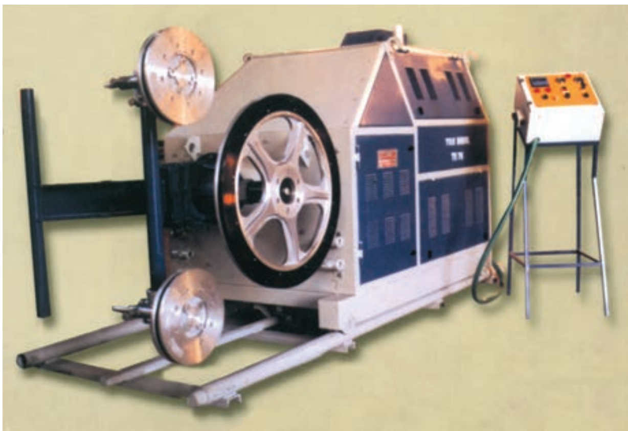
شکل ۱۱-۵- دستگاه سیم برش دیزلی
