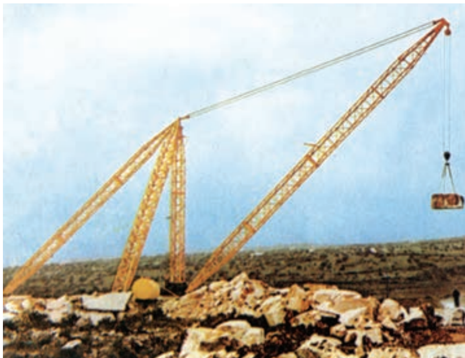
شکل ۲۲-۵- جرثقیل مخصوص حمل بلوک‌های سنگ استخراجی
