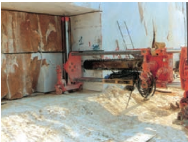
شکل ۱۵-۵- تیغه برنده در حین استخراج سنگ
