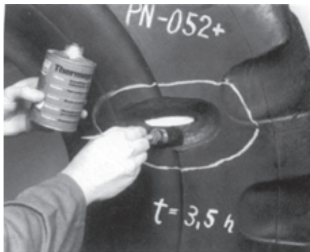
شکل ۶-۶-۱۶- چسب زدن محدوده‌ی حفره‌ی ترکیدگی
