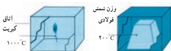
شکل ۱-۱- دمای شعله کبریت بیشتر از بلوک فولادی است با وجود این بلوک فولادی گرمای بیشتری را در وجود خود دارد و هوای اتاق را بیشتر گرم خواهد کرد.
