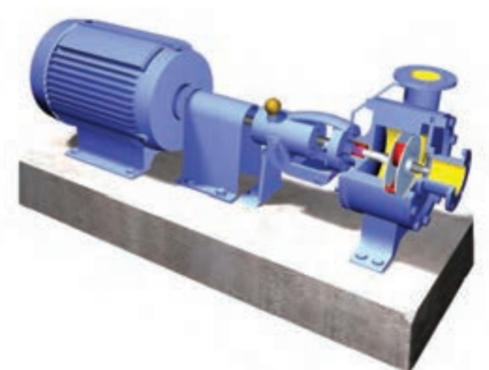
شکل ۵-۷ - یک موتور پمپ زمینی
