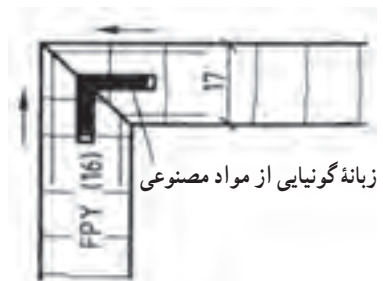
شکل ۲-۶۶- ترسیم علائم اتصال قلیف زبانه سراسری از جنس مواد مصنوعی
