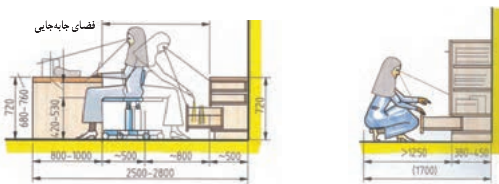
شکل ۵-۱۸- اندازه انسان برای مکان منشی و دسترسی به قسمت های مختلف مبیل
