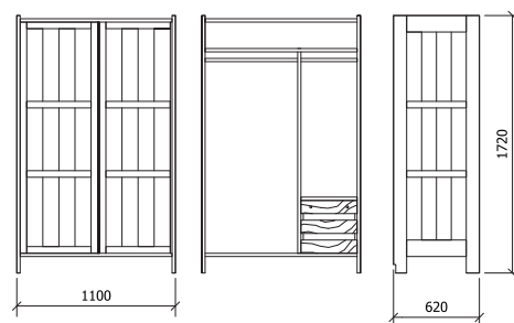
شکل ۳۷-۵ ترسیم نماهای کابینت با تقسیمات داخل آن
