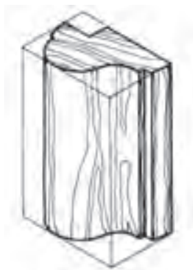
شکل ۱-۳۳- تصویر مجسم ایزومتریک قطعه ابزار خورده به صورت کامل شده
