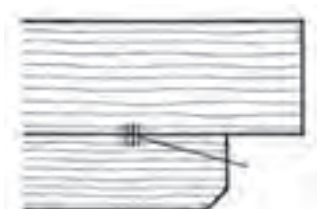
شکل ۶-۲- ترسیم هاشور راه چوب ماسیو قطعات به هم چسبیده
