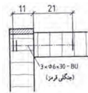
شکل ۲-۶۰- طریقه ترسیم دوپل ساده با خط محور
