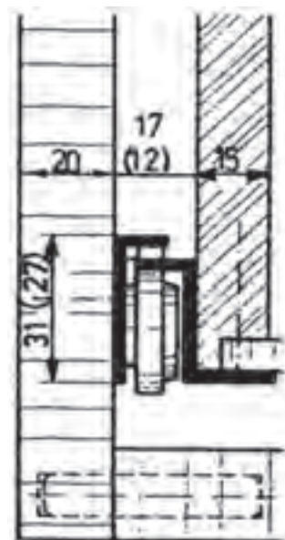
شکل ۲-۱۰۹- هدایت مکانیکی ساده (۲) با بلبرینگ دقیق. ریل هادی در زیر بدنه جعبه نصب شده است.
