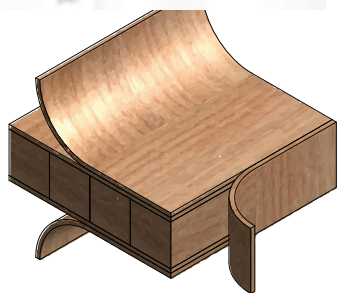
شکل ۲۳-۲- نقشه صفحه تخته لایه درودگری چوب به ضخامت ۱۹ میلی متر که با احتساب ضخامت روکش‌ها ۲۰ میلی متر است.
