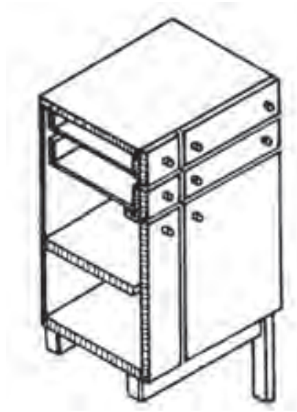
شکل ۳-۵۸- برش حاصل که در جهت B-B دیده و رسم شده برش طولی است.
