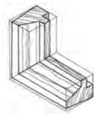
شکل ۱-۳۱- تصویر مجسم ایزومتریک گوشه قاب به صورت کامل شده
