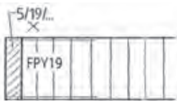
شکل ۲-۱۳ - علائم اختصاری تخته خرده چوب دو طرف روکش شده سر چوب با ضخامت ۱۹ میلی‌متر و زهوار 5 \times 19 میلی‌متر
