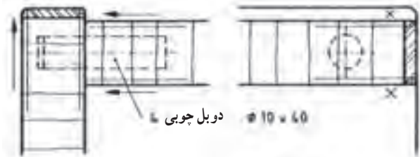
شکل ۲-۶۲- طريقة ترسیم اتصال دوبل در صفحات چوبی به وسیله ۴ دوبل به قطر ۱۰ mm و طول ۴۰ mm در برش نمای روبه‌رو و نمای پهلو با فاصله خالی
