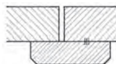
شکل ۷-۲- ترسیم هاشور سرچوب ماسیو قطعات به هم چسبیده
