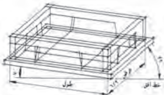
شکل ۱-۵۰- روش ترسیم طرح اولیه تصویر مجسم دیمتریکی از یک جعبه و صفحه زیر آن
