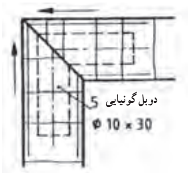
شکل ۲-۶۳- طريقة ترسیم دوبل گونیایی به قطر ۱۰ mm و به طول ۳۰ mm در برش
