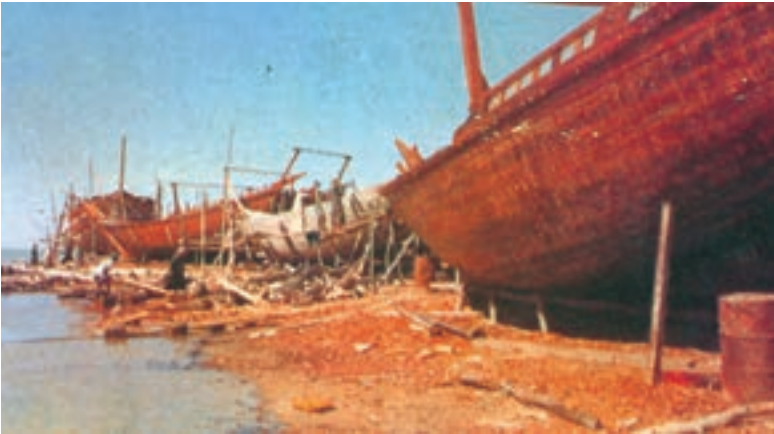
شکل ۱۴-۲- کارگاه ساخت سنتی شناورهای چوبی در سواحل خلیج فارس و دریای عمان
