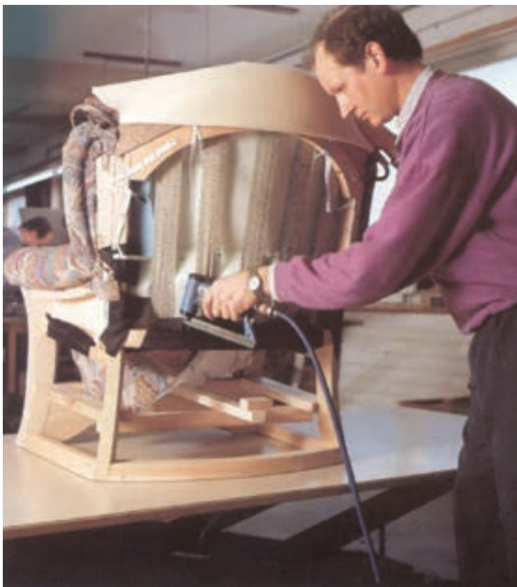
شکل ۵-۶۳- نمونه نوارکشی برای رویه کوبی پارچه روی پشتی صندلی
