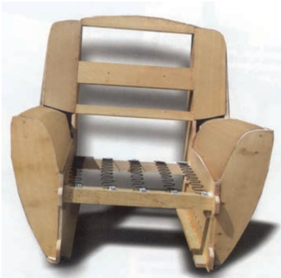
شکل ۵-۶۲- نمونه‌ی فتر کوبی کف مبیل
