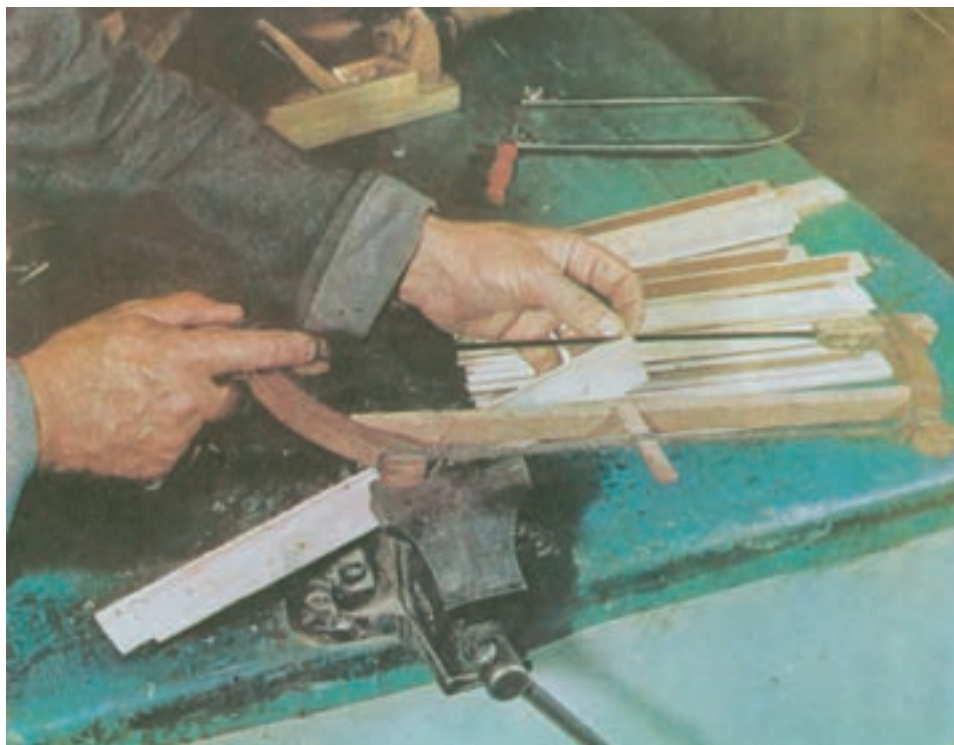
شکل ۱۷-۶- نحوه‌ی برش خاتم آسترشده
