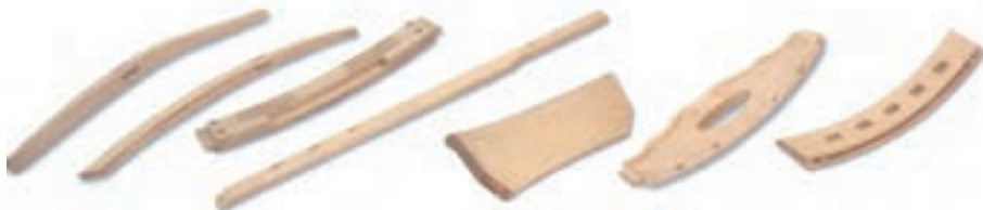
شکل ۱۷-۵ - ماشین CNC - ساخت قطعات مبلمان از چوب ماسیو
