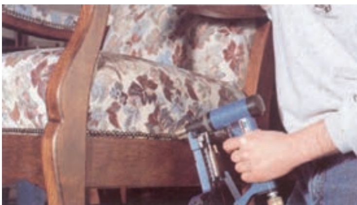
شکل ۷۲-۵- نوارکوبی درز دوخت رویه کوبی
