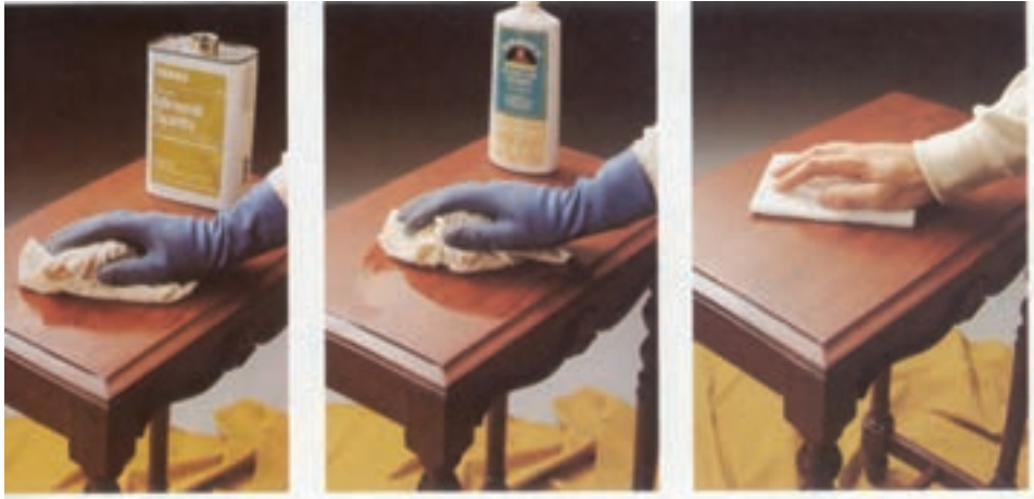
شکل ۱۲-۵- واکس زدن با پارچه
