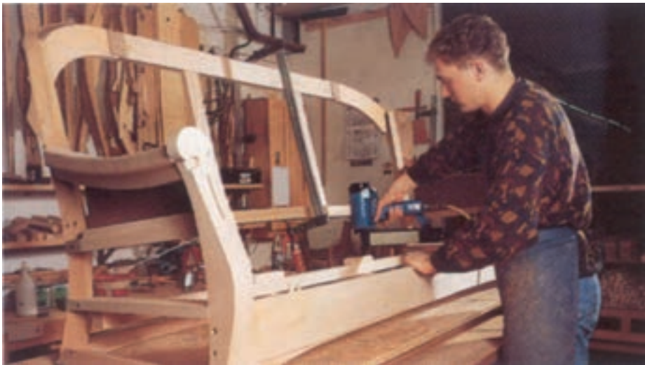
شکل ۶۹-۵- آماده سازی کلاف برای نوارکشی و فتر بندی
