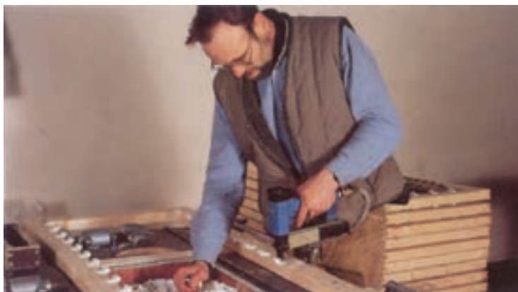
شکل ۷۰-۵- کوبیدن بست‌هایی برای قرار دادن دو سر فنرها
