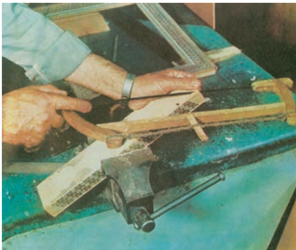
شکل ۱۶-۶- نحوه برش قامه و تهیه دو زاویه
