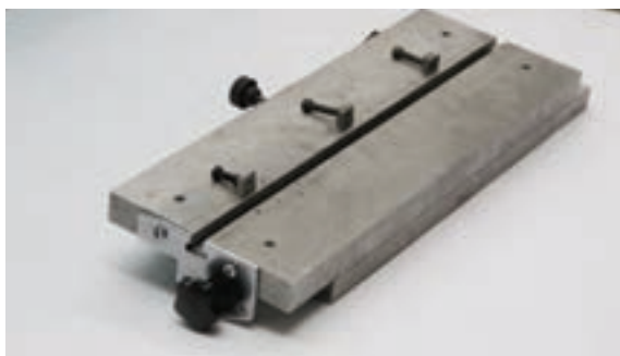
شکل ۵-۲۶ میز شیاردار- فیکسچر به همراه مهره های
