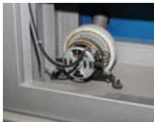
شکل ۵-۱۶ سیستم وکیوم دستگاه چاپ اسکرین
