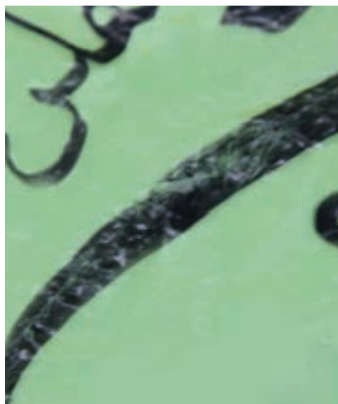
شکل ۱۳-۲ تطابق نداشتن سطح زیر چاپ با خاصیت پلاستیک کنندگی
