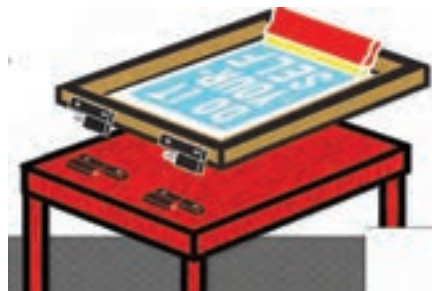
شکل ۲۶-۴ پیچ و لولا به همراه خروسک
