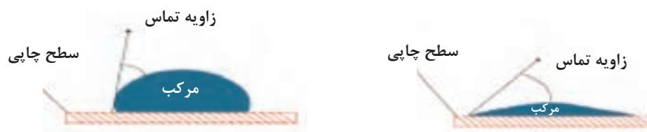
شکل ۴۰-۳ رابطه انرژی سطحی و زاویه تماس
