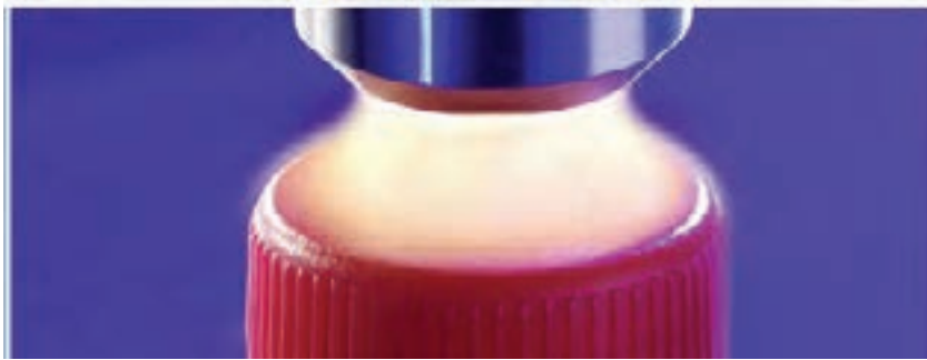
شکل ۳-۴۶ روش گاز پلاسما
