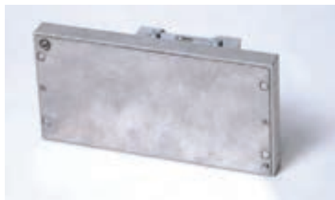
شکل ۴-۵۲ نشان دهنده نگهدارنده مخزن مرکب
