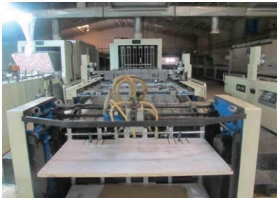
شکل ۲-۲۲ ماشین تمام اتوماتیک اسکرین با سرعت بالا
