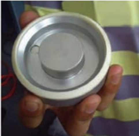
شکل ۴-۵۵ مخزن مرکب آهن ربای مرکزی
