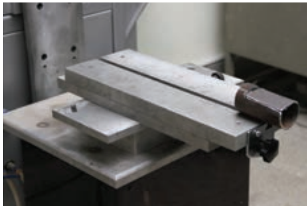
شکل ۵-۸ بستن قالب جای میز دستگاه
