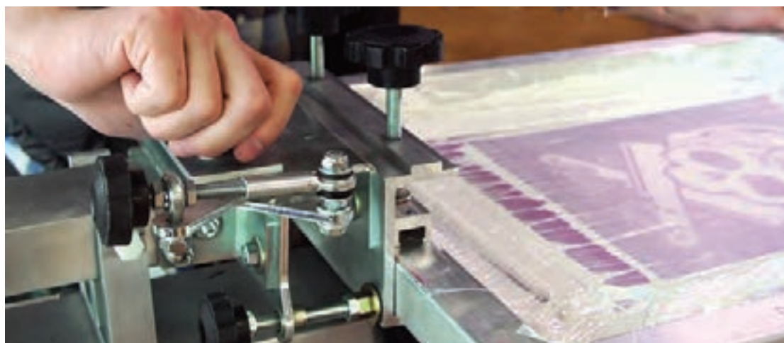
(شکل ۴-۴) گونیا کردن طولی و عرضی شابلون
