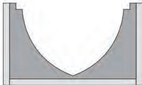
شکل ۴-۸۹ قالب یک بالشتک استاندارد
