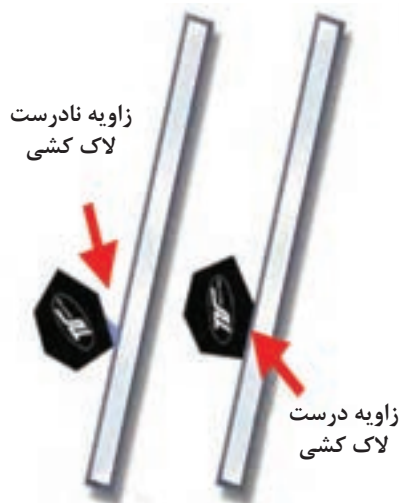
شکل ۲-۱- الف - زاویه لاک کش دستی
