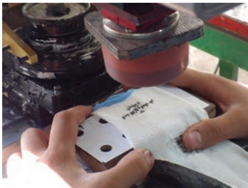
شکل ۳-۳۷ چاپ یک دستکش کار به روش بالشتکی
