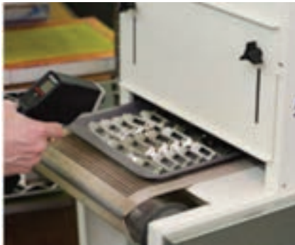
شکل ۳-۶۷- سنجش میزان حرارت خشک کن شکل
