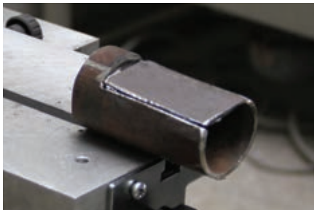
شکل ۲۴-۵ فیکسچرهای اندازه متغیر
