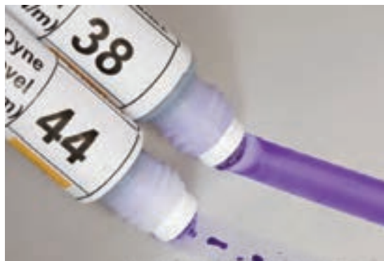
شکل ۳-۴۳ روش استفاده از ماژیک تستر
