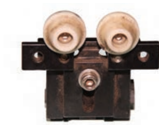
شکل ۲۵-۵ فیکسچرهای بلبرینگ دار
