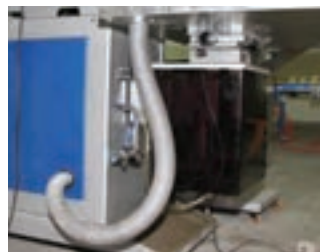
شکل ۵-۱۶ سیستم وکیوم دستگاه چاپ اسکرین
