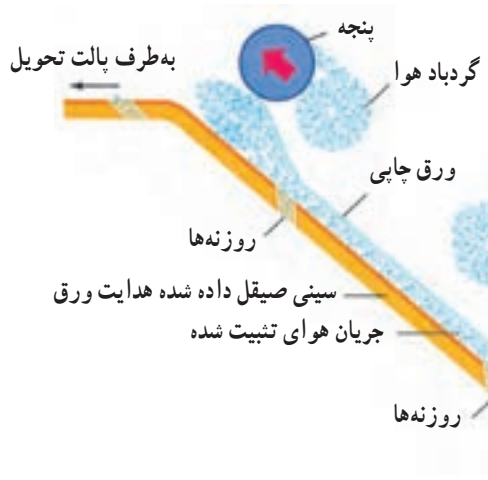
شکل ۳۸-۴- تثبیت ورق چاپی توسط سیستم هدایت هوا مجهز به روزنه‌های ونتوری
