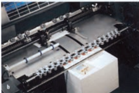
شکل ۴-۱- سیستم تغذیه تک برگی و نمودار انتقال ورق
