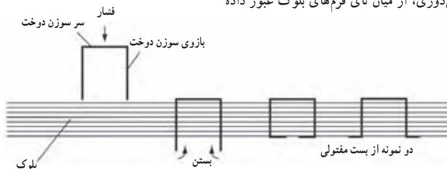
شکل ۵-۵- روش کار دوخت مفتولی و انواع بست مفتولی
