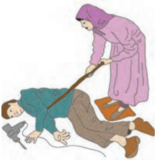
شکل ۸- نحوه صحیح جدا کردن فرد از برق
