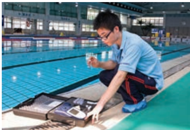
شکل ۶- نمونه برداری از آب استخر
