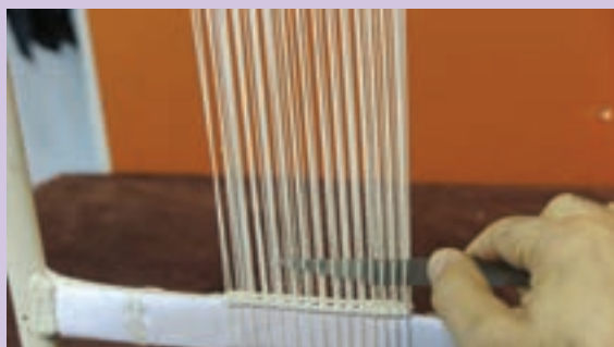
روش اشتباه در دست گرفتن سیخ پودکشی و حرکت آن
