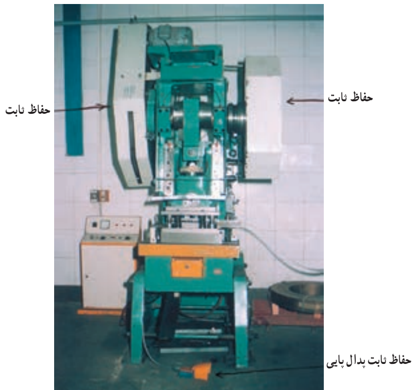
شکل ۹-۶- حفاظهای ثابت در محلهای گردان یک دستگاه برس و حفاظ ثابت روی پدال پای
