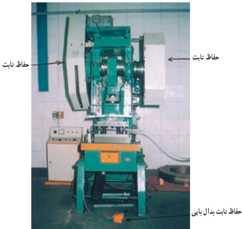
شکل ۹-۶- حفاظهای ثابت در محلهای گردان یک دستگاه برس و حفاظ ثابت روی پدال پایی
