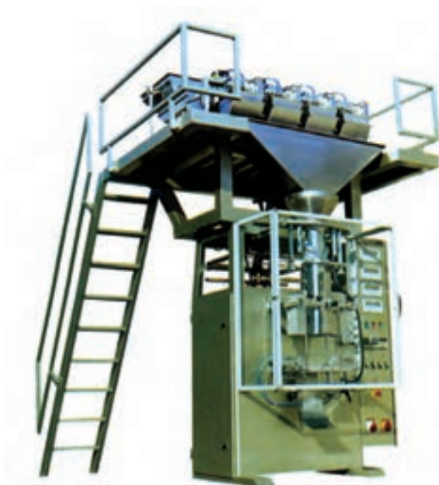
شکل ۲-۸ - ماشین بسته‌بندی برنج، چای، خشکبار، چیپس، تافی، آبنبات، بیسکویت و غیره
