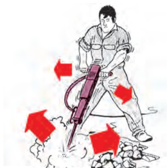
شکل ۲-۳- عوارض ناشی از ارتعاش
