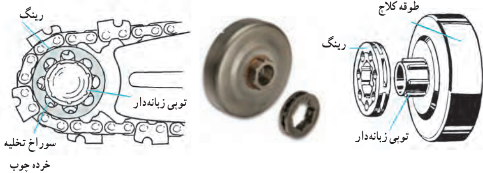
شکل ۷-۲- چرخ زنجیر رینگ‌دار
