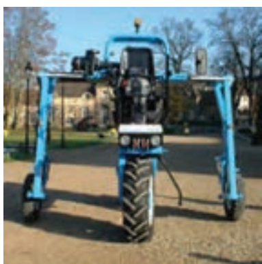
شکل ۴-۱- یک نوع تراکتور ویژه نهالستان
