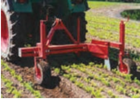
شکل ۱۵-۴- تیغه تراکتوری هرس ریشه
