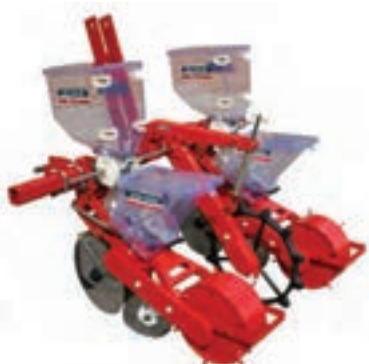
شکل ۹-۴- بذرکار دو ردیفه تراکتوری مجهز به کودکار
