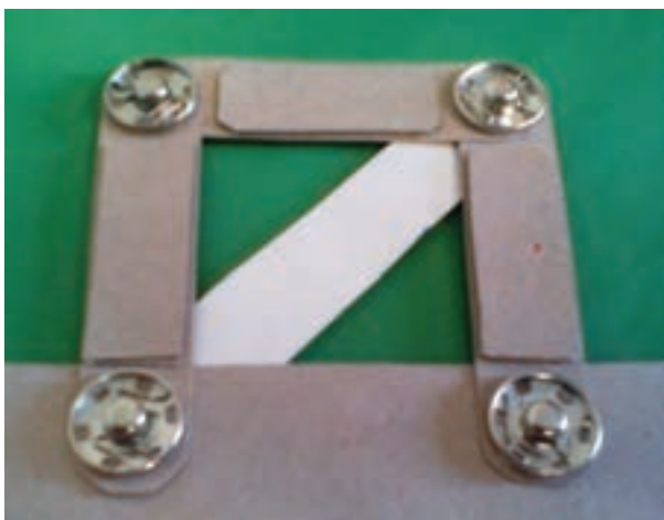
شکل ۱-۶- ماکت قاب ساختمانی ساده مهاربندی شده
