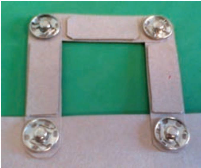
شکل ۴-۱- ماکتی از قاب ساختمانی ساده مهاربندی نشده
