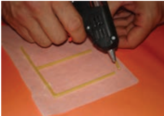
شکل ۲-۴- نحوه ساخت قاب ساختمانی با ماکارونی با استفاده از
