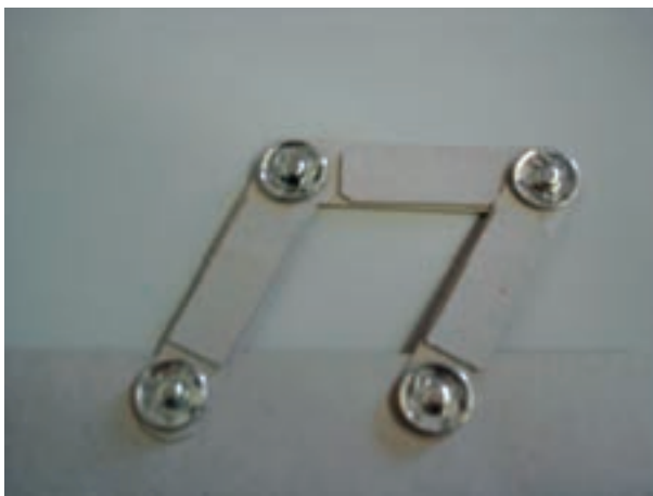
شکل ۱-۵- جابه‌جایی قاب ساختمانی ساده مهاربندی نشده
