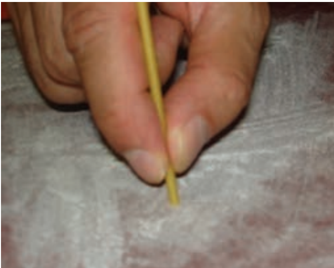
شکل ۲-۲- نحوه سنباده کردن و اندازه کردن ماکارونی
