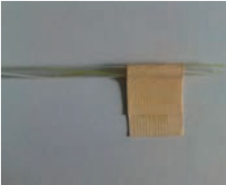
ت- نحوه اتصال یکی از نوارهای کاغذی به پاتاقان (نی پلاستیکی)
