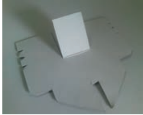
الف- بریدن محل قرارگرفتن قرقره (اندازه برش باید از طول قرقره کمی بزرگتر باشد).
