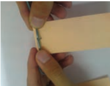
ج- پیچاندن کاغذ دور لوله به اندازه قطر سوراخ قرقره نخ
