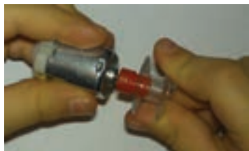
چ - محکم کردن مجموعه روی محور
