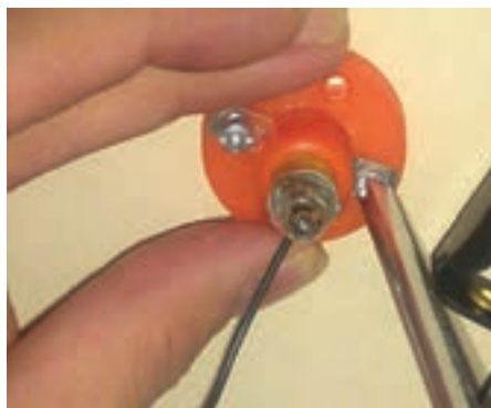
الف- بستن لامپ ۳ ولتی روی سرپیچ و بستن دو سرسیم جای باتری به دو سر اتصال سرپیچ
