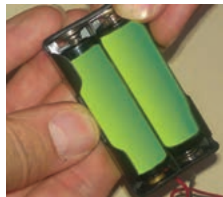
پ- قرار دادن باتری قلمی دوم در جای باتری به طور صحیح
