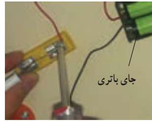
الف- جدا کردن سر یک سیم جای باتری و اتصال دادن آن به محل اتصال کلید اهرمی
