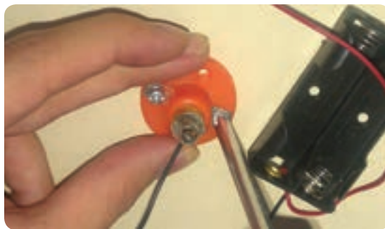
شکل ۳-۷ اتصال سیم به سریچ و کلید با استفاده از سیم رابط و پیچ‌گوشی
