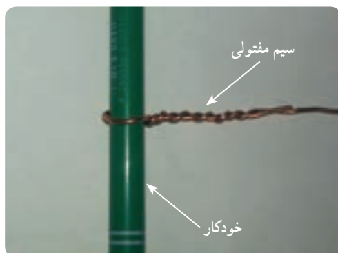
شکل ۳-۴- شکل‌دهی سر سیم مفتولی به صورت دایره
