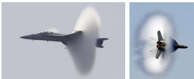
شکل ۱ - در این شکل اثر چگالش بخار آب تحت تاثیر فشار و پدیده شکست دیوار صوتی مد نظر است.
