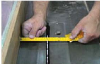
روش تنظیم گونیای اره مجموعه ای برای تنظیم عرض برش
